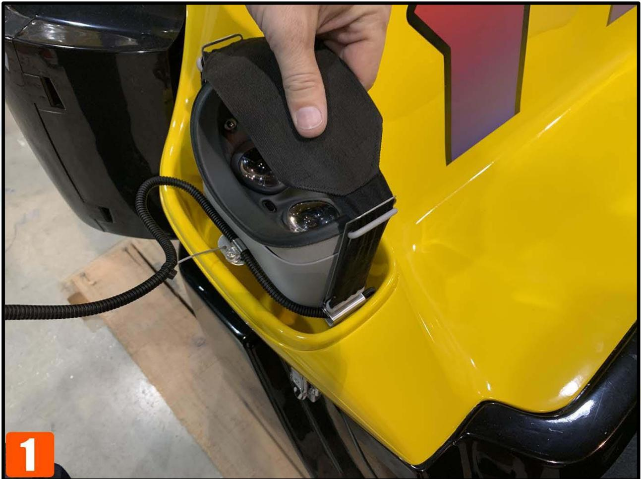
**STEP 2 – INSERTING THE HEADSET CABLE THROUGH THE BACK DISPLAY**
